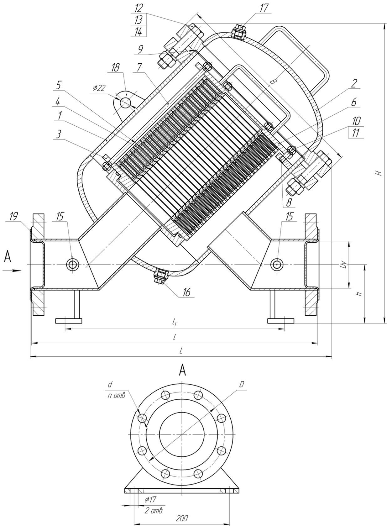
1 - корпус; 2, 6 - крышки; 3 - основание; 4 - диски; 5 - сетки; 7, 8 - шпильки; 9 - прокладка; 10, 13 - гайки; 11, 14 - шайбы; 12 - болты; 15, 16, 17 - пробки; 18 - петля грузовая; 19 - заглушки
